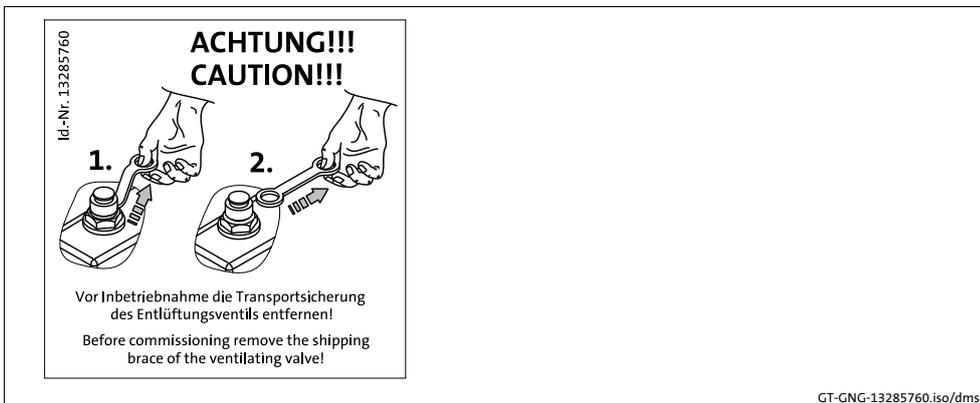
Lose beigefügte Entlüftungen (abweichend vom Standard) nach Kap. 5.2.5 montieren. Getriebe, die für mehrere Einbaulagen (📖 15) geeignet sind, werden ohne Entlüftung ausgeliefert.
