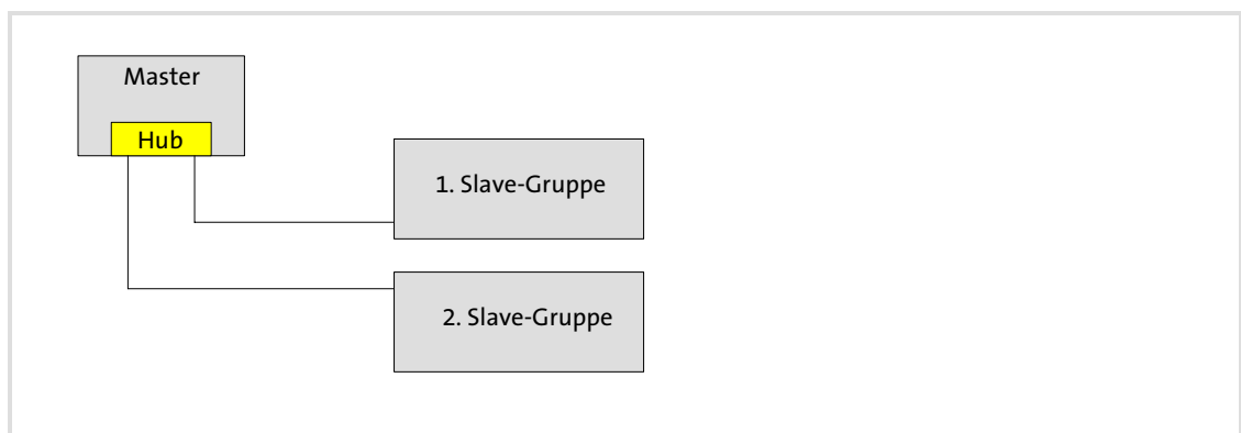
Abb. 5-2 Stern-Topologie für 1 bis 2 Slave-Gruppen
