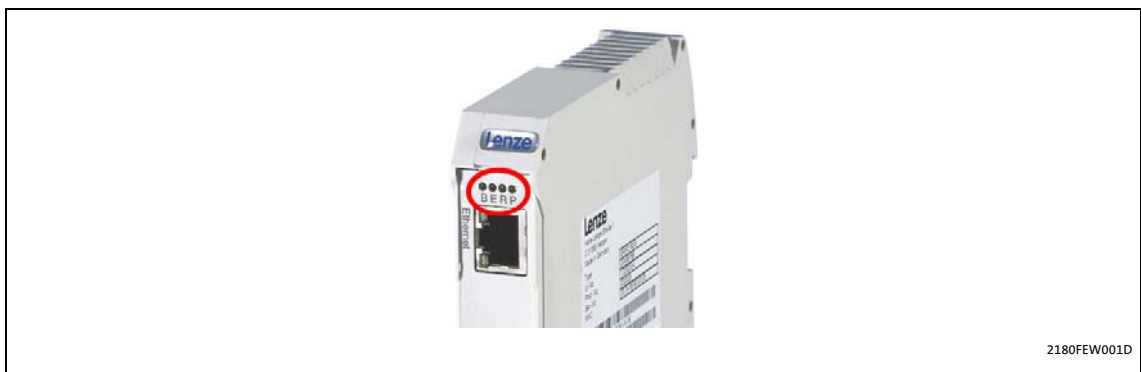
[8-1] LED-Statusanzeigen zum Kommunikationsmodul und zur CAN-Kommunikation
