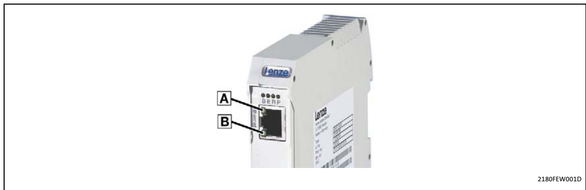
[8-2] LED-Statusanzeigen zur Ethernet-Kommunikation
